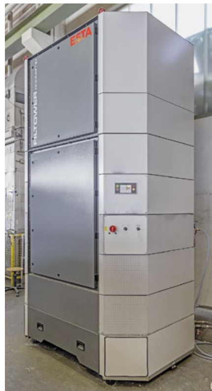
Saubere und warme Luft im Winter: Die Filtertürme sind an die Heizungsanlage gekoppelt. (Bild: ESTA)
